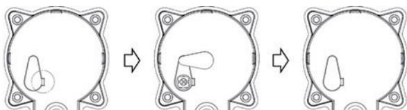
1. 从缺口处打开橡胶密封塞下部堵住的孔，上部的孔不要打开
