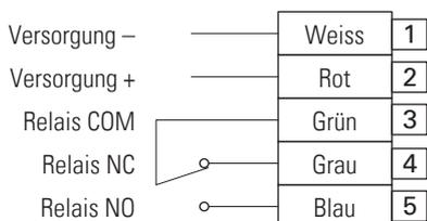
Abisolierlänge min. 8.5 mm (Volldraht oder flexibler Draht)
