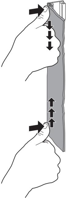
Gummirastnocken müssen vollständig im Aluprofil einrasten.
