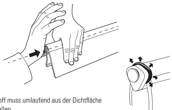
Dichtstoff muss umlaufend aus der Dichtfläche überquellen.
