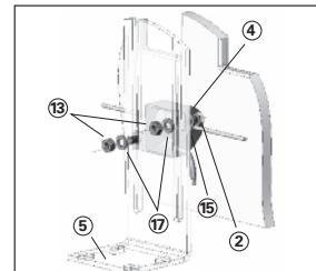
Montage de l'équerre avec bobine INT-FIX 50
