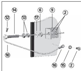
Montage de l'équerre côté tension
