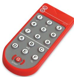
借助 RegloBeam 2 双向远程操作，可以从地面快速方便地配置 Herkules 2E。每个参数都可以根据相应的场合进行调整。
