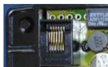
Au choix, borne à vis enfichable ou connexion RJ12
