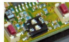
Programmation de base grâce aux touches situées sur le capteur
