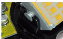
Module de radar avec tramage réglable aux niveaux horizontal et vertical
